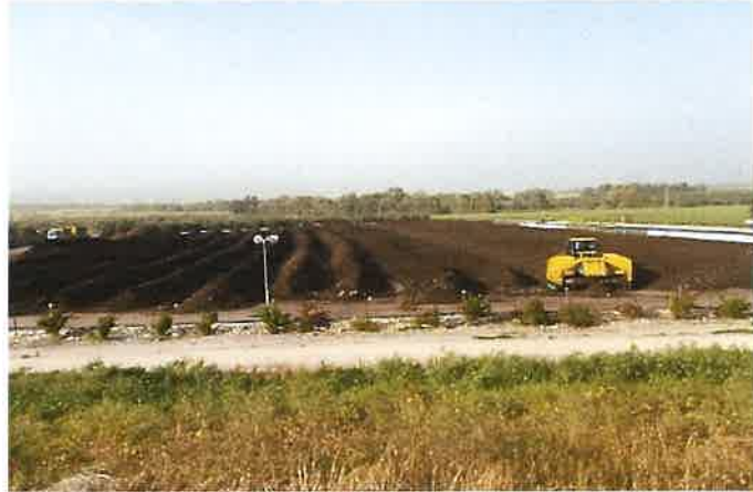
איור 2. קומפוסטציה בערימות (windrows) במבנה סגור ובשטח פתוח
